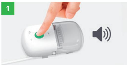
Mettez la pompe en pause en appuyant sur le bouton vert de démarrage et en le maintenant enfoncé pendant deux (2) secondes. La pompe émet deux bips pour confirmer qu'elle est en mode pause.
