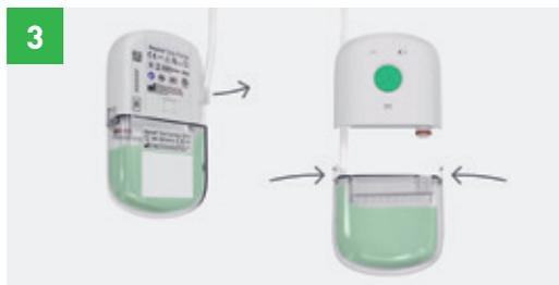
Détachez la tubulure à l'arrière de la pompe. Pour enlever le réservoir, appuyez sur les boutons latéraux en plastique et tirez. Fixez le nouveau réservoir. Veillez à ce que le réservoir soit bien fixé, afin de garantir l'étanchéité du dispositif.
