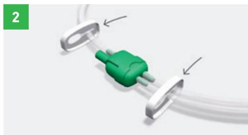
2 Clampez la tubulure du réservoir et la tubulure du pansement en positionnant les clamps coulissants à côté des connecteurs verts et faites-les glisser sur les tubulures jusqu'à ce qu'ils soient fixés.
